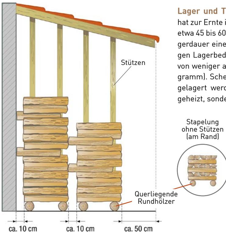
**Lager und Trocknungsdauer.** Frisches Holz hat zur Ernte im Winter einen Wassergehalt von etwa 45 bis 60 %. In Mitteleuropa genügt die Lagerdauer eines ganzen Sommers unter günstigen Lagerbedingungen, um auf Wassergehalte von weniger als 20 % abzutrocknen (siehe Diagramm). Scheitholz kann auch unter Dach eingelagert werden, aber der Raum sollte nicht geheizt, sondern gut durchlüftet sein.
