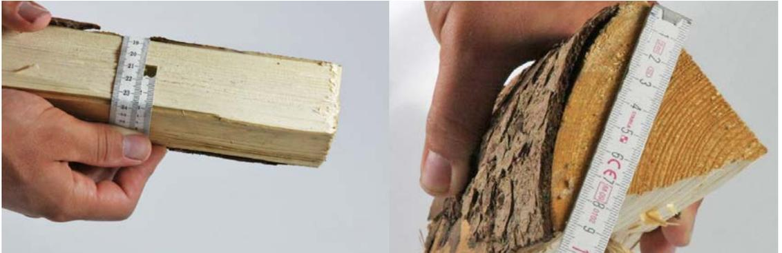
Ein Umfang von ca. 20 cm (links) entspricht etwa einem Durchmesser von 9 cm (rechts).
