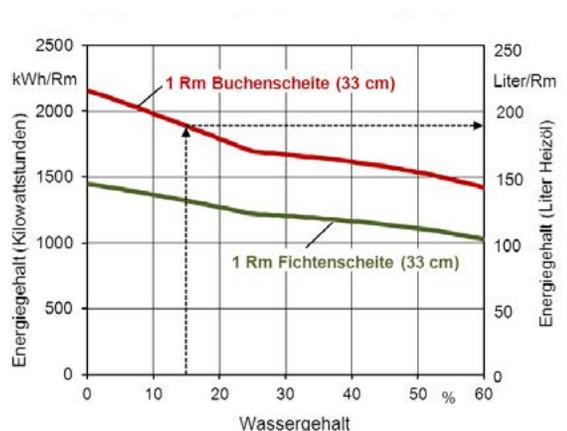
Der Wassergehalt beeinflusst den Energiegehalt eines Holzstapels (Unterhalb von 25 % Wassergehalt beginnt die Schrumpfung)
