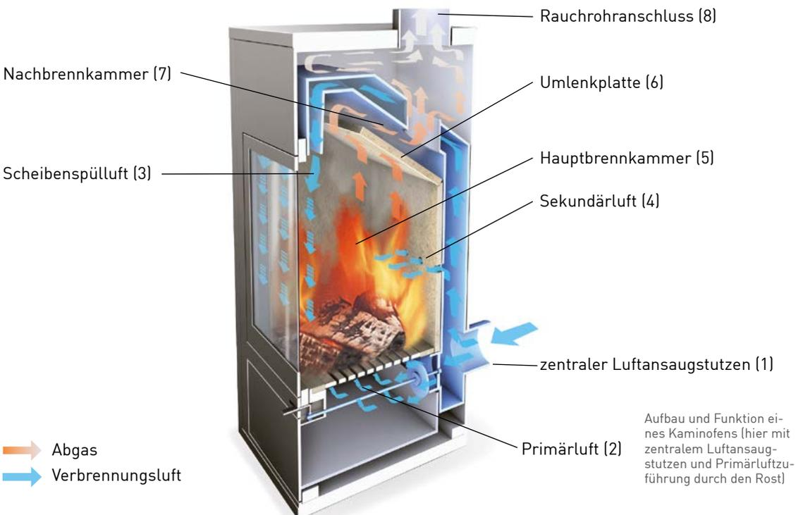
In weniger luftdichten Gebäuden oder wenn die Verbrennungsluft problemlos auch aus dem (großen) Aufstellraum entnommen werden kann, wird kein Zuluftkanal und somit auch kein zentraler Luftansaugstutzen benötigt.
