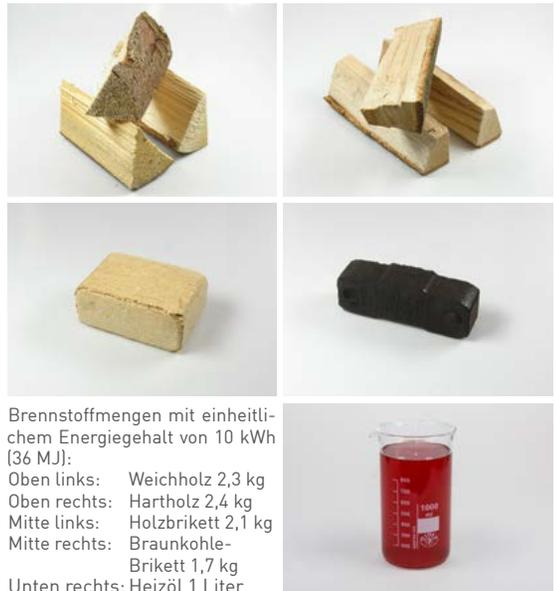
Brennstoffmengen mit einheitlichem Energiegehalt von 10 kWh (36 MJ):
